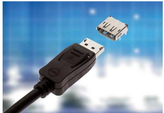
DisplayPort 링크는 메인 링크, AUX 채널 및 HPD(Hot Plug Detect) 라인으로 이루어져 있습니다. 메인 링크는 AC 커플된 단방향 통신을 지원하며, 1, 2, 또는 4 레인의 사용이 가능합니다.
